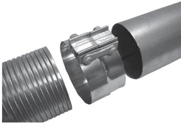
Posicione el SealClamp alrededor del tubo más pequeño. El lado más ancho de la abrazadera debe ir sobre puesto en el tubo.
