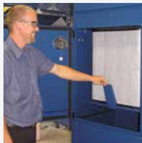
Palanca de un pivote retiene en forma segura el elemento de filtrado primario.
